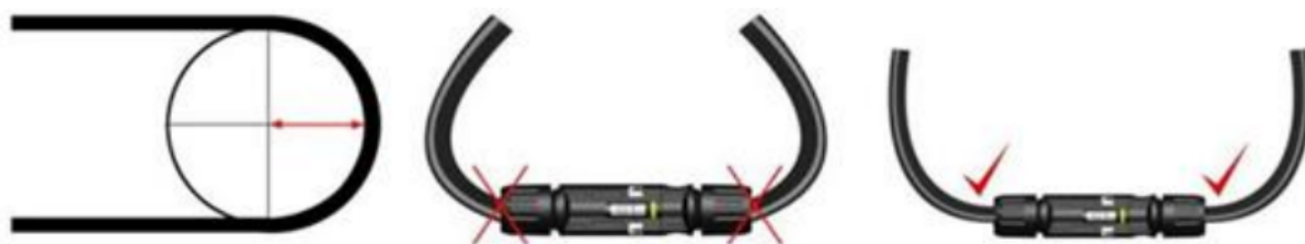
図 6-2 ケーブルの最小曲げ半径
